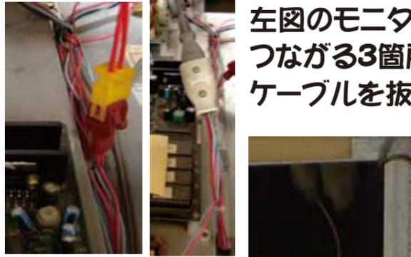
③ ケーブルを全て接続し、開閉の妨げ、及び基盤への接触がおきないように、付属のケーブル固定具を使い、ケーブル類をまとめます。
