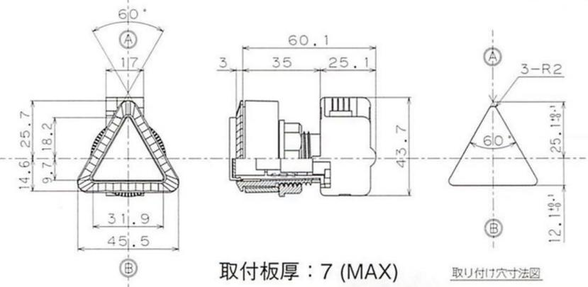
取付板厚：7 (MAX)      取り付け穴寸法図
