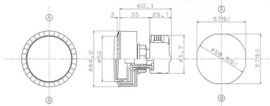
取付板厚：3 (MAX) 取り付け穴寸法図
