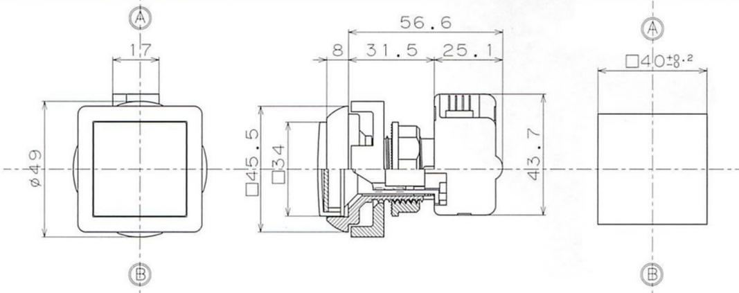
取付板厚：7 (MAX)      取り付け穴寸法図
