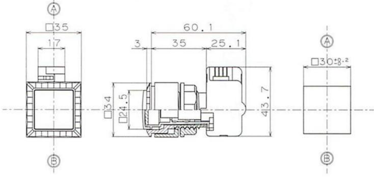
取付板厚：7 (MAX)      取り付け穴寸法図
