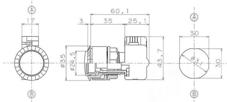
取付板厚：7 (MAX) 取り付け穴寸法図
