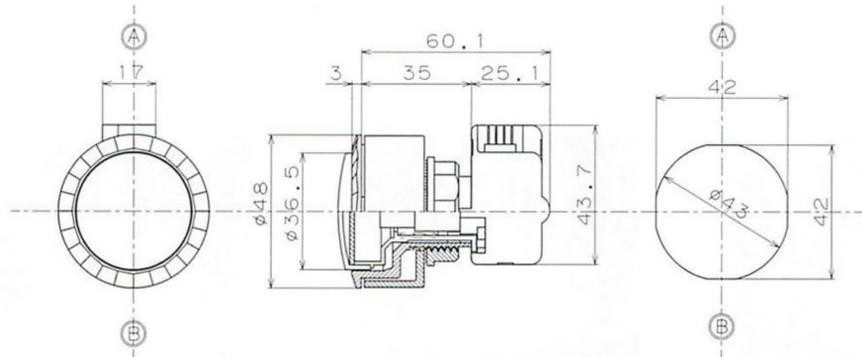
取付板厚：3 (MAX) 取り付け穴寸法図
