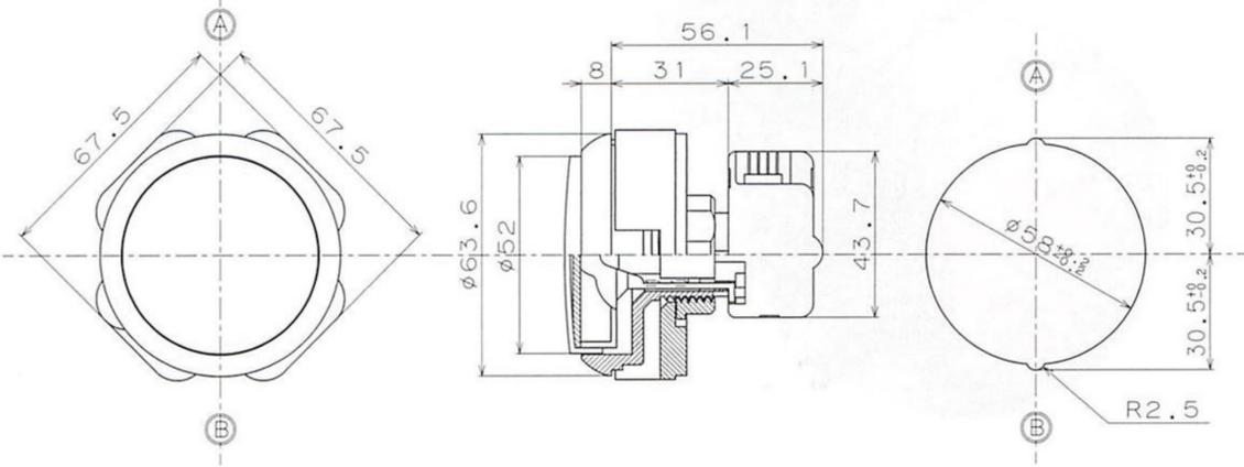
取付板厚：2 (MAX)      取り付け穴寸法図
