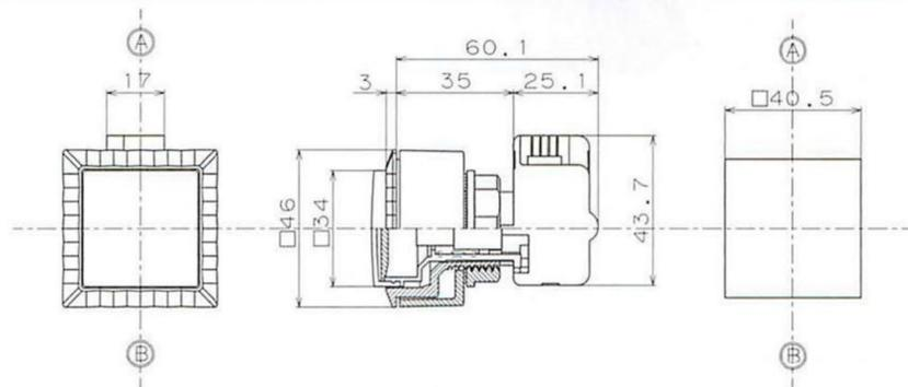
取付板厚：3 (MAX) 取り付け穴寸法図
