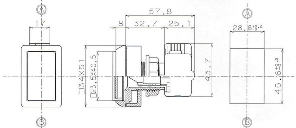
取付板厚：7 (MAX)      取り付け穴寸法図
