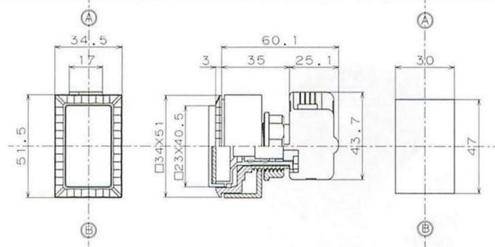
取付板厚：3 (MAX) 取り付け穴寸法図
